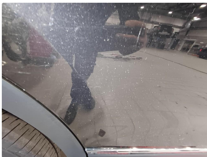
1.1 Noen riper og småbulker
