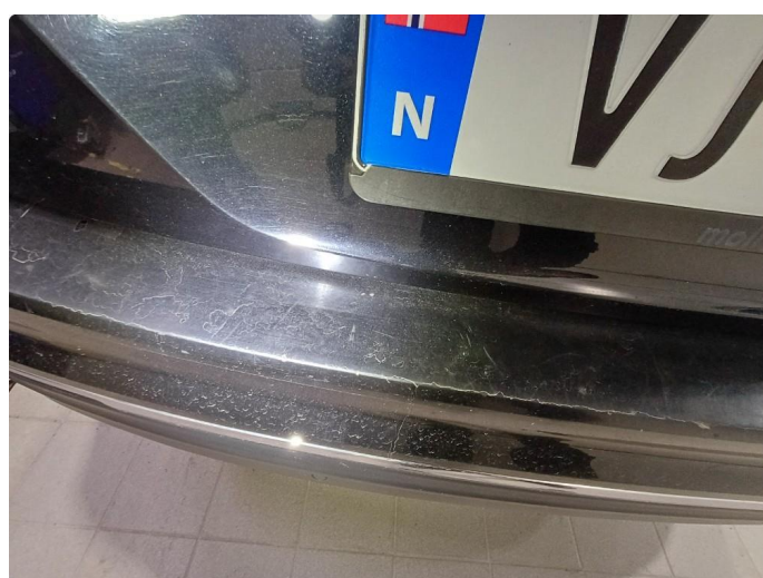
1.1 Noen riper og småbulker
