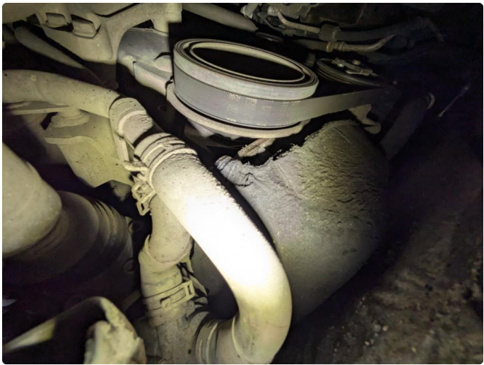
2.1 Dynamoreim slitt. Blir skiftet.
