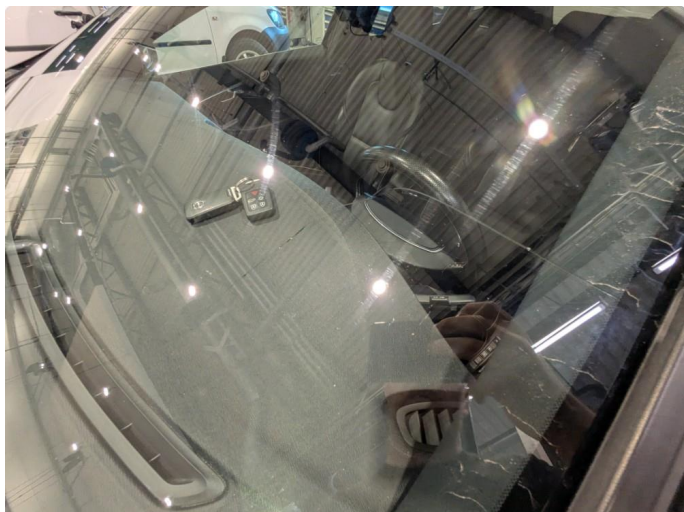
1.1 Sprekk, denne skal skiftes.
