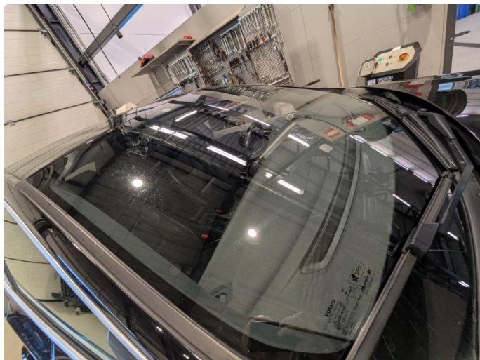
1.1 Sprekk, denne skal skiftes.
