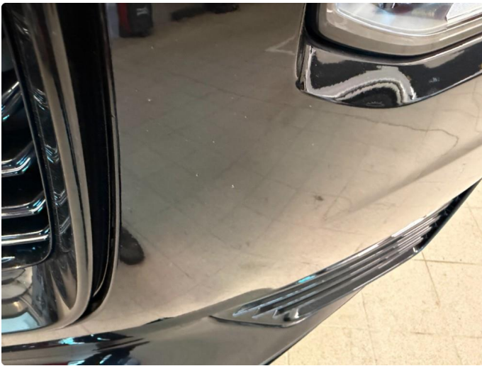
1.1 Noen steinsprut og slitasjemerker
