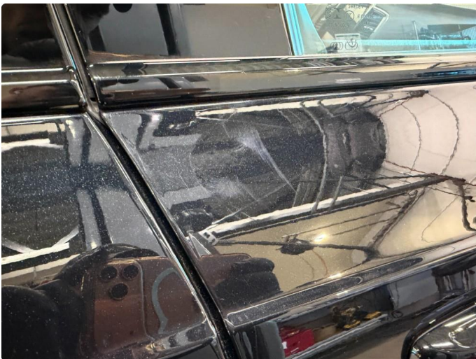
1.1 Noen steinsprut og slitasjemerker
