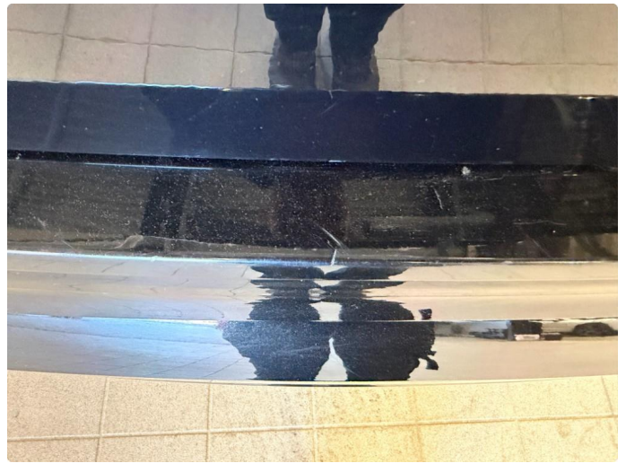
1.1 Noen steinsprut og slitasjemerker
