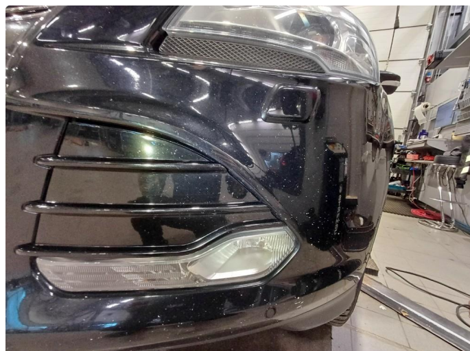
1.1 Noen riper og småbulker
