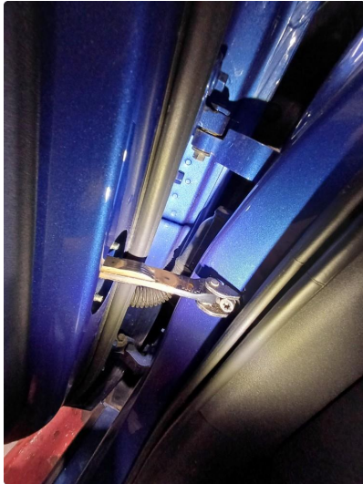
1.1 Dørstopper defekt, blir byttet
