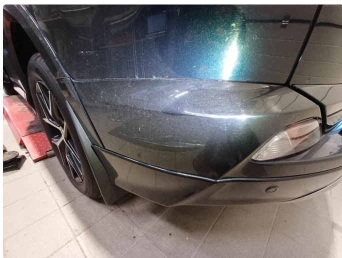
1.1 Noen riper og småbulker
