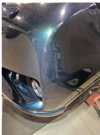
1.1 Noen riper og småbulker
