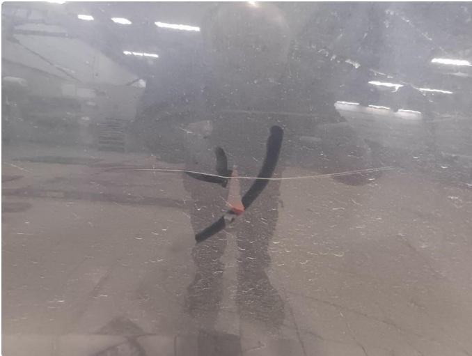
1.1 Noen riper og småbulker. Skade på venstre bakdør. Døren blir skiftet.
