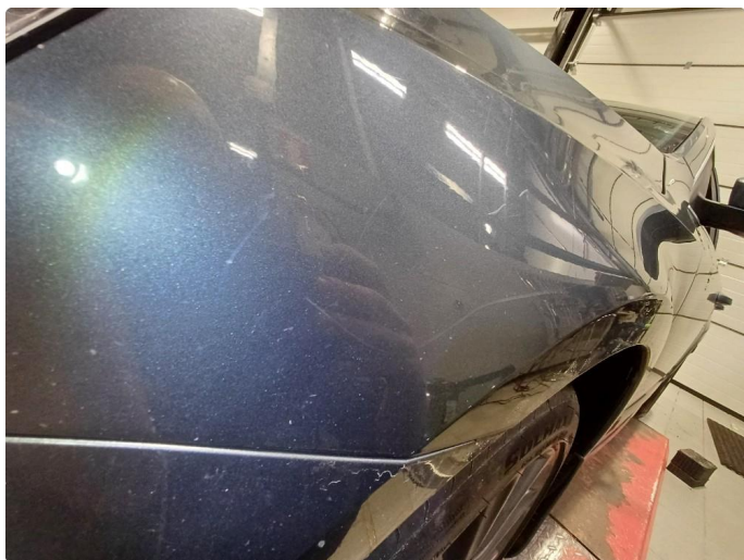
1.1 Noen riper og småbulker
