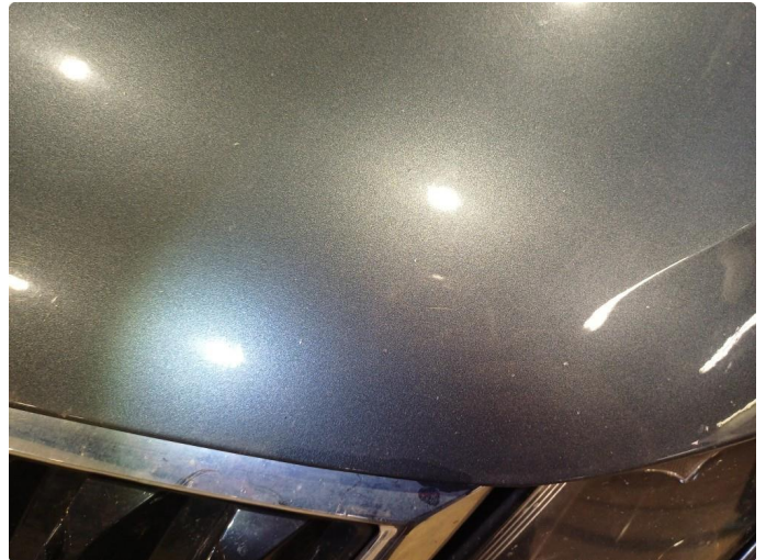
1.1 Noen riper og småbulker
