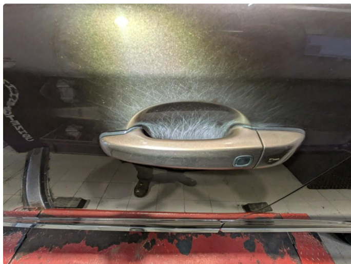
1.1 Noen riper og småbulker
