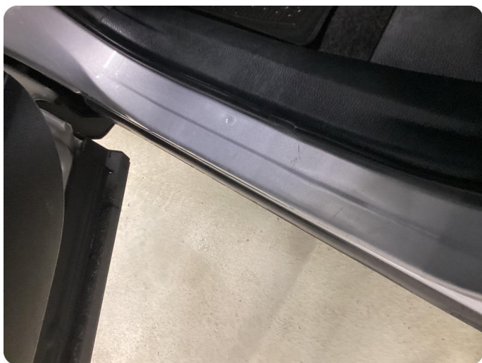
1.1 Noen bulker med lakkskader Venstre bak dør
