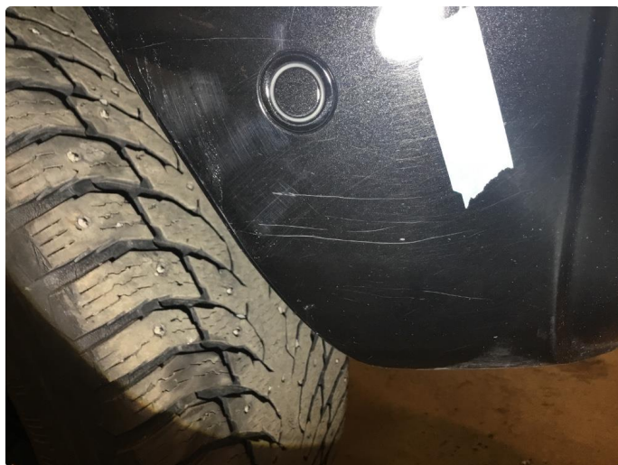
1.6 Noe riper høyre fangerhjørne foran.
