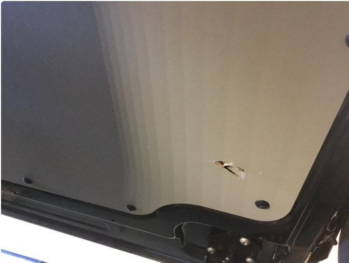
1.1 Mindre skade dørtrekk v.skyvedør.
