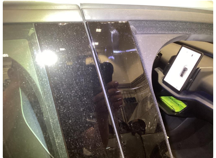
1.1 Bruksslitasje i lister, Polert opp
