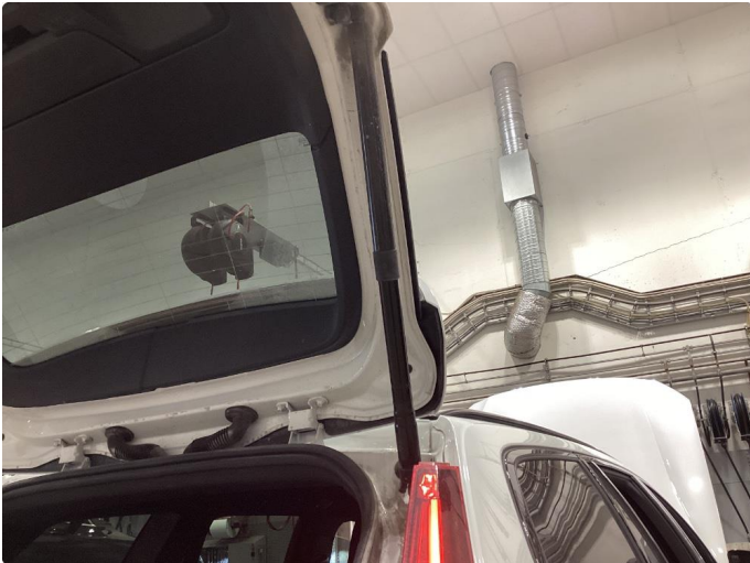
1.1 Dempere defekt - Byttet
