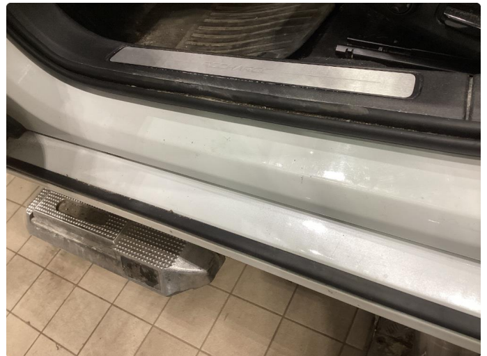
1.2 Litt slitasje i innsteg
