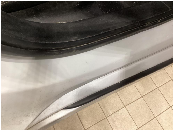
1.2 Litt slitasje i innsteg
