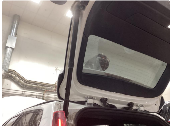
1.1 Dempere defekt - Byttet
