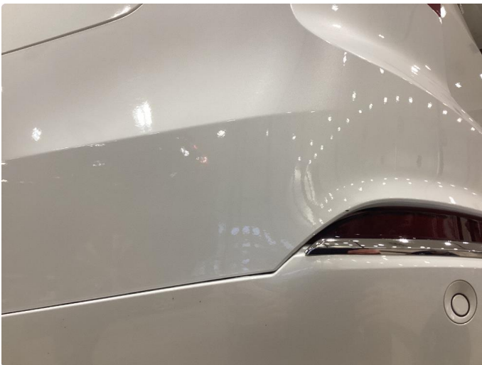
1.7 Ripe(r) ned til grunning
