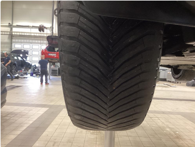
1.1 Byttet sommerdekk pga lite mønster
