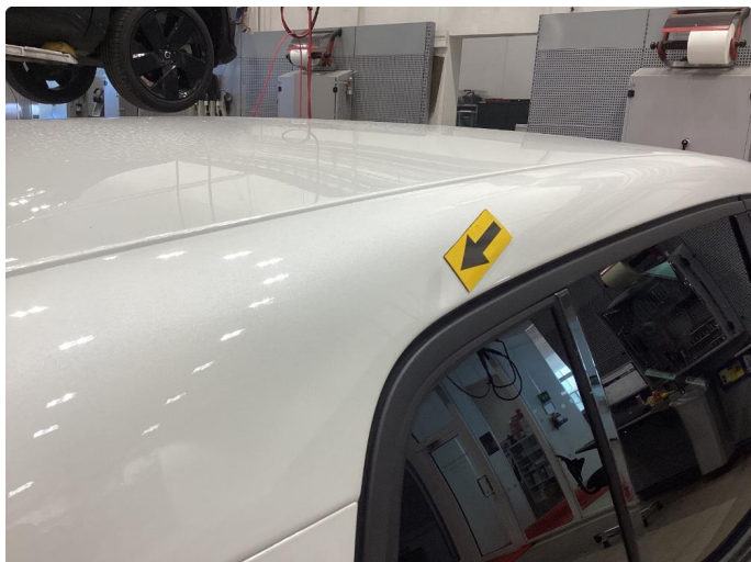
1.3 Bulk uten lakk skade - fikset
