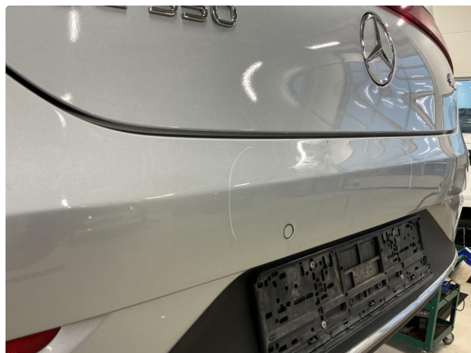
1.2 Lakk er flekket litt bak
