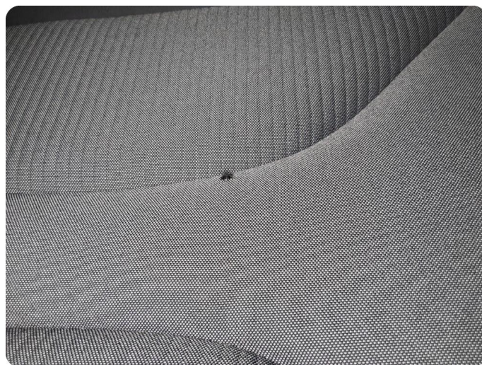
2.1 Skade på setepute Minimal rift i setepute høyre bak
