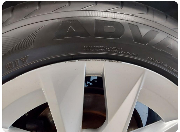
1.1 Kantkjørt felg Liten skade fra kantkjøring VB, kosmetisk skade
