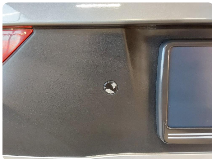
1.1 Lakk flasser Lakkflassing på ryggesensorer bak
