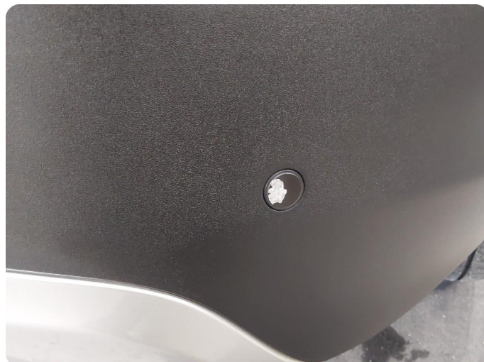
1.1 Lakk flasser Lakkflassing på ryggesensorer bak
