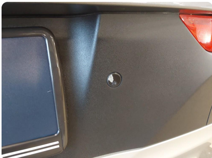
1.1 Lakk flasser Lakkflassing på ryggesensorer bak
