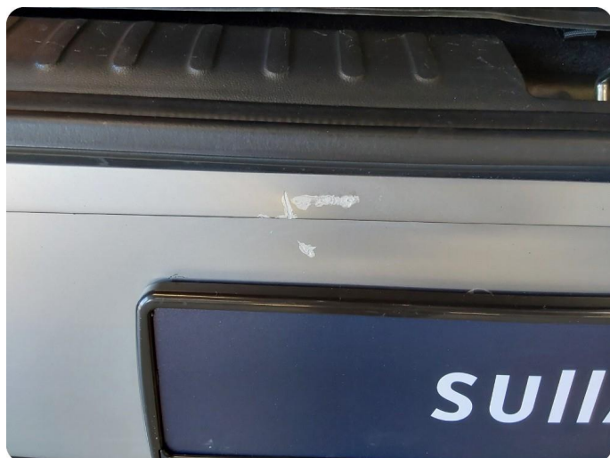
1.3 Skade 2 små skader på midtre del bakfanger
