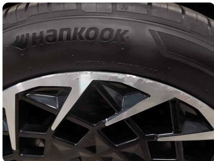
1.2 Kantkjørt felg Kantkjørt Sommerfelg HF
