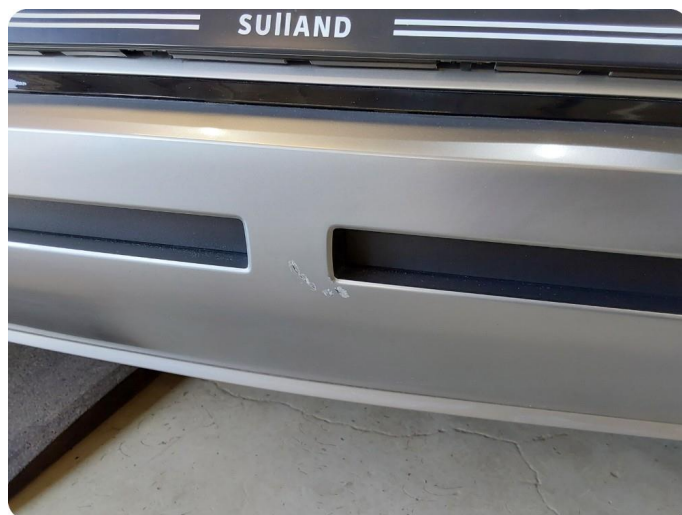
1.3 Skade 2 små skader på midtre del bakfanger
