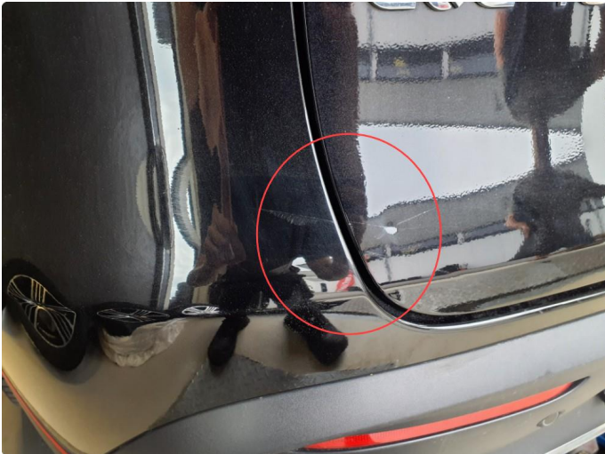
1.1 Bulk med lakkskade halv del
