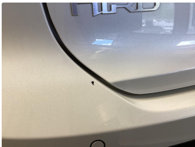
1.5 Ripe(r) ned til grunning
