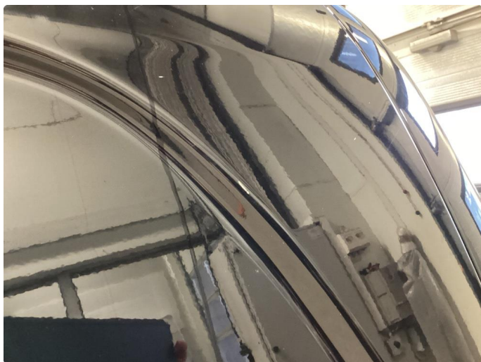
1.5 Ripe(r) ned til grunning
