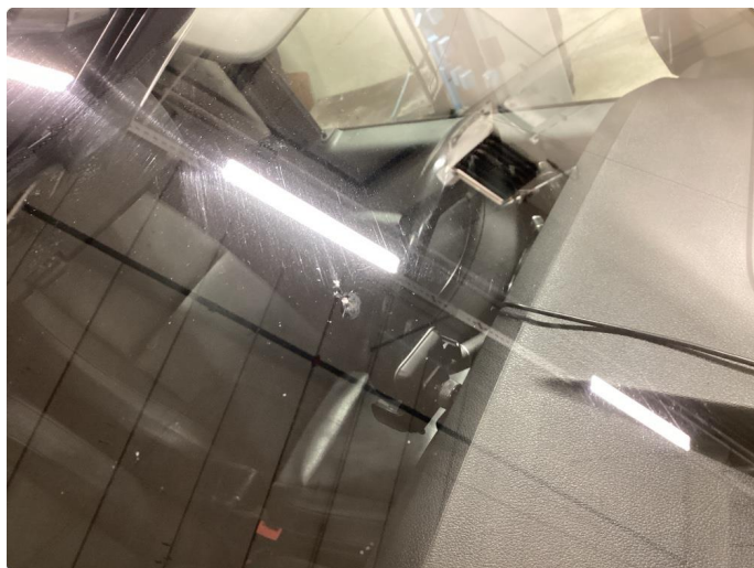
1.10 Steinsprut med sprekk
