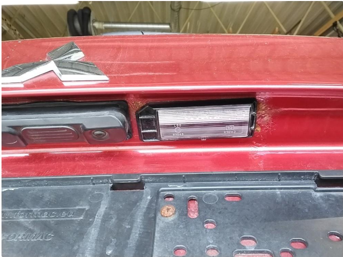
1.1 Riper i lakk og rust
