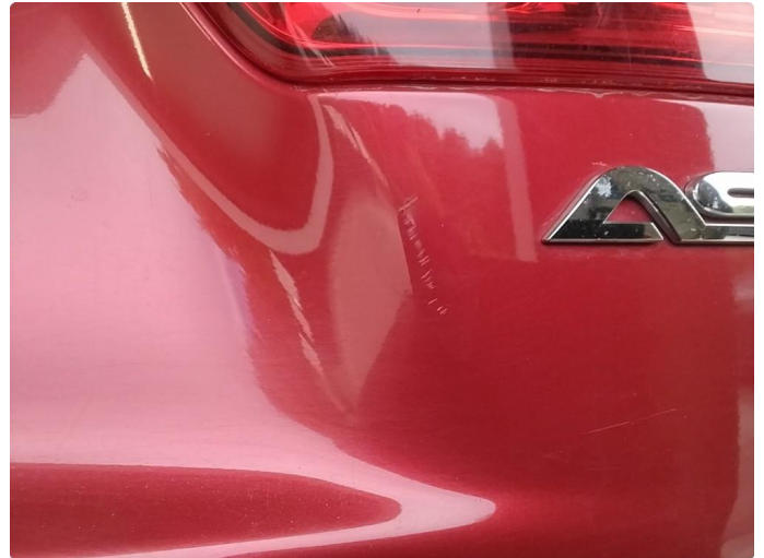
1.1 Riper i lakk og rust
