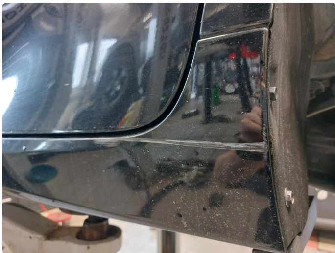
1.1 Noen riper og småbulker
