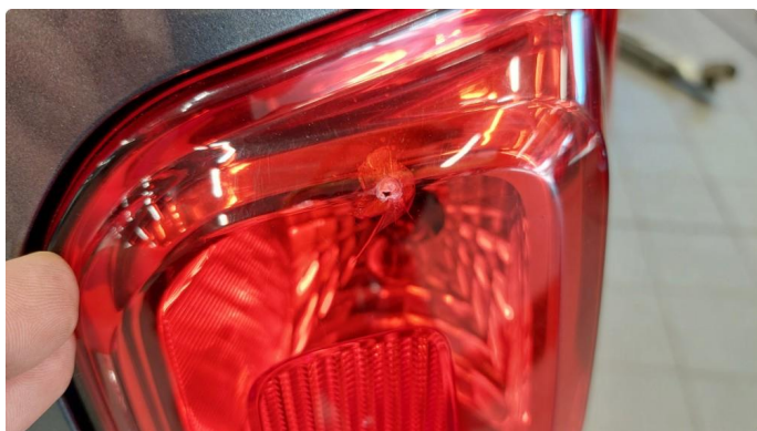
2.1 Defekt / sprukket glass
