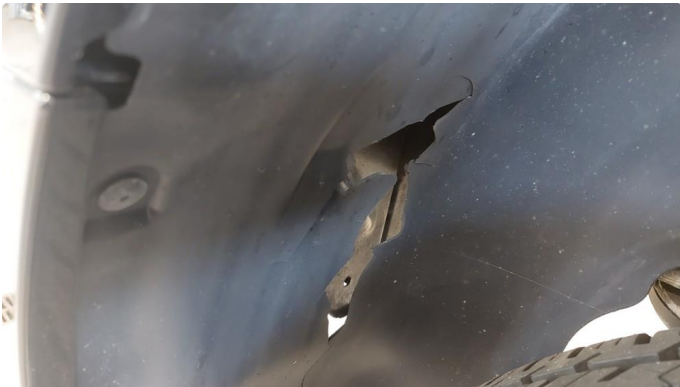
1.1 Hjul bue deksel skadet
