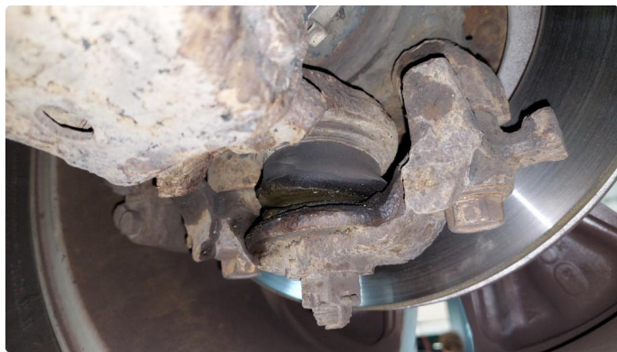
4.2 Mansjett bærekule defekt
