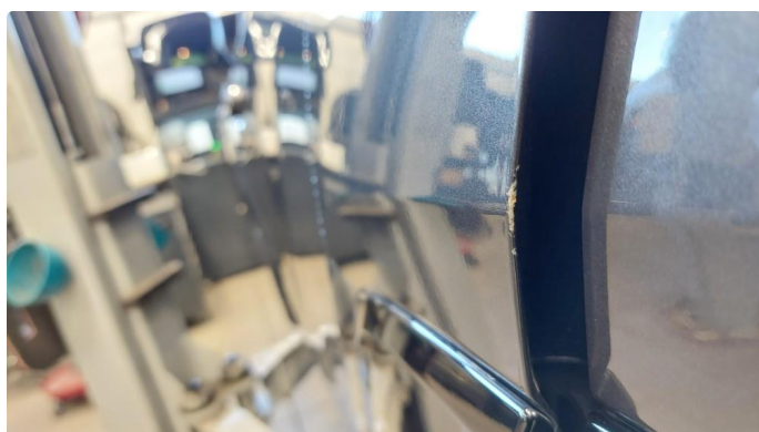
1.2 Steinsprut med rust
