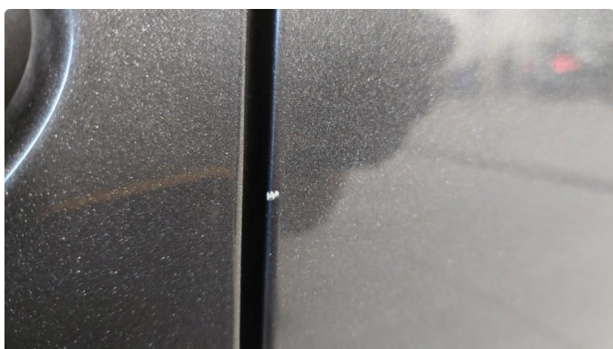
1.2 Steinsprut med rust
