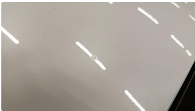
1.3 Steinsprut med rust
