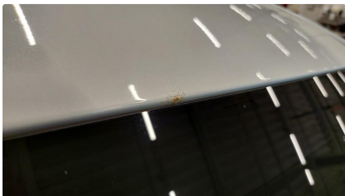
1.3 Steinsprut med rust
