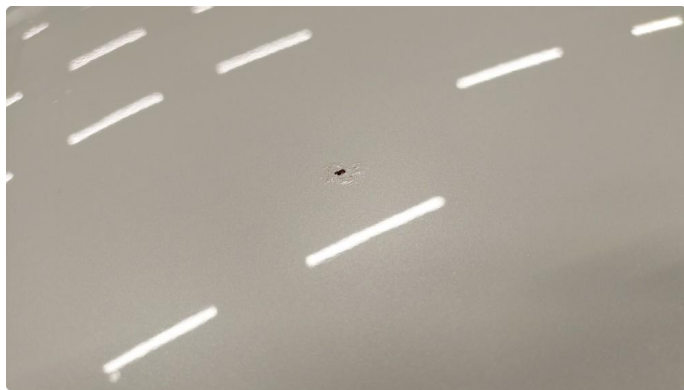
1.3 Steinsprut med rust
