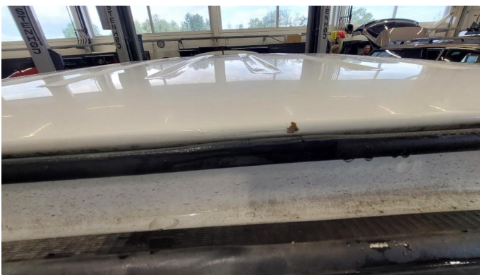
1.9 Steinsprut med rust
