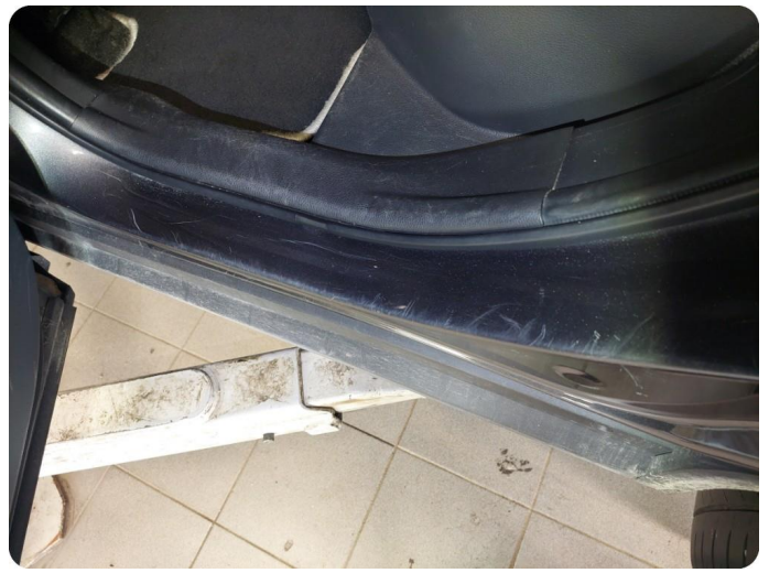
1.3 Ripe ned til grunning Døråpning har mange ripper og noen som er ned til grunning VSB alle døråpninger har ripper dør HSF skade ved åpning
