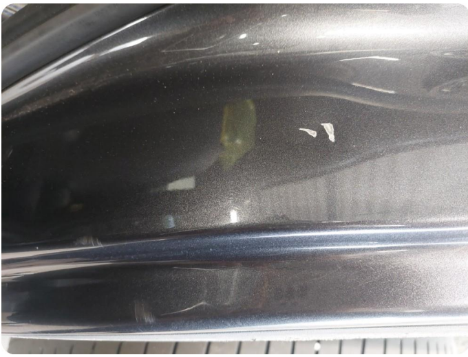
1.3 Ripe ned til grunning Døråpning har mange ripper og noen som er ned til grunning VSB alle døråpninger har ripper dør HSF skade ved åpning
