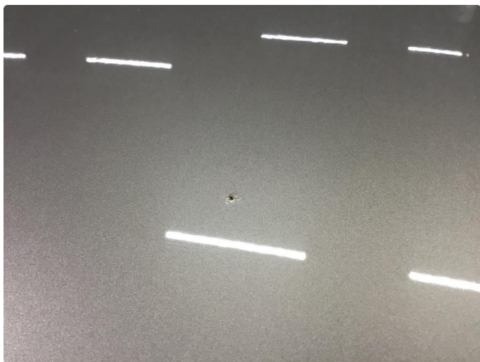
1.9 Steinsprut med rust
