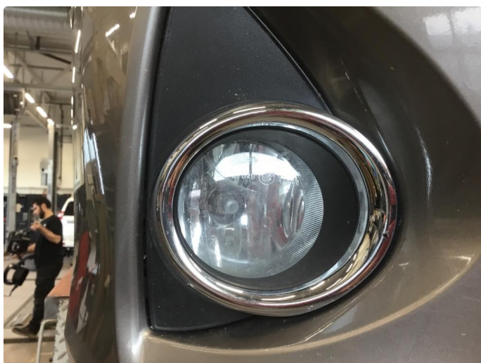
2.1 Tåkelys - defekt / sprukket glass
