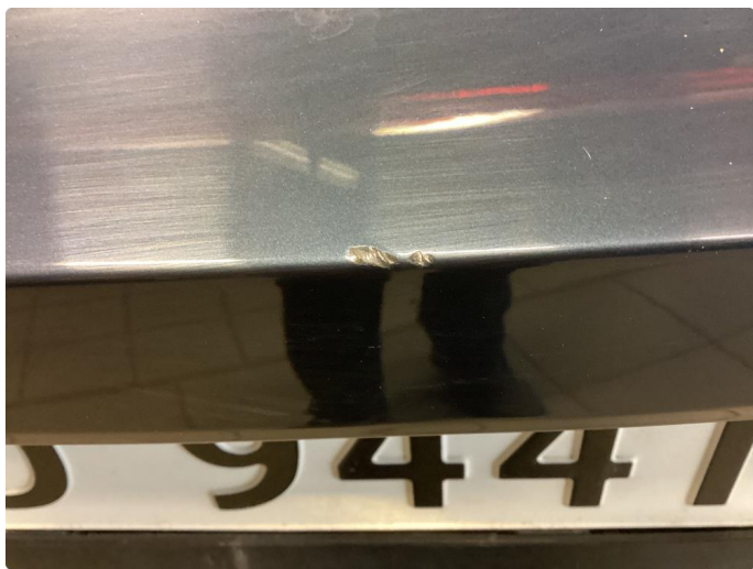
1.3 Ripe(r) ned til grunning
