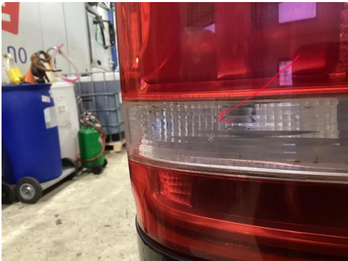
2.1 Ripe / Sprekk i lykteglass. Ikke lekkasje i lykten.
