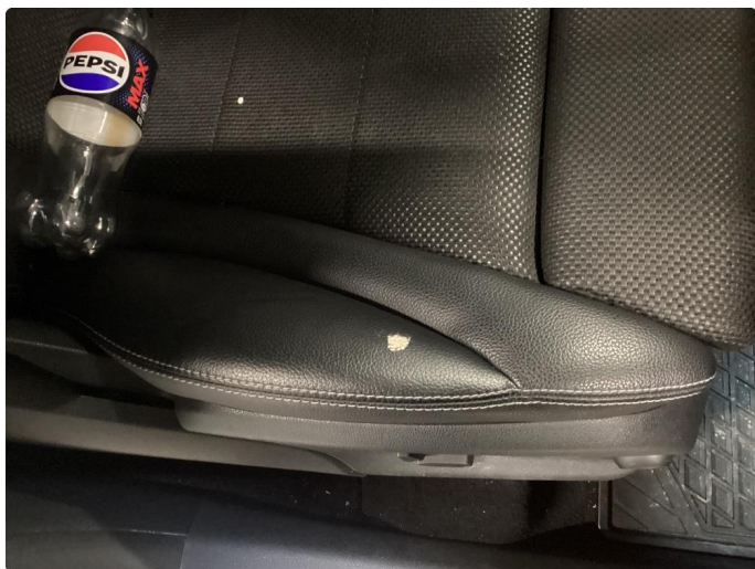
2.1 Skade på ytterste lag, setepute
