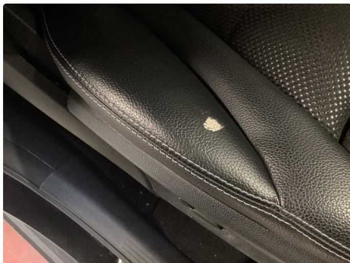
2.1 Skade på ytterste lag, setepute
