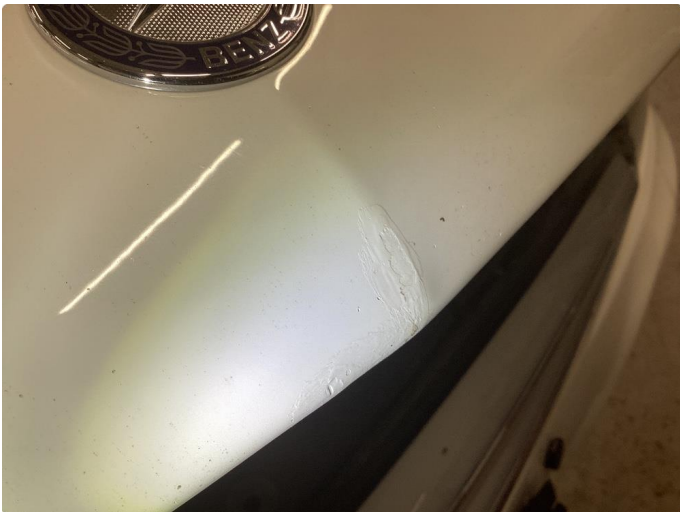
1.2 Flekking av lakk - ufagmessig utført arbeid
