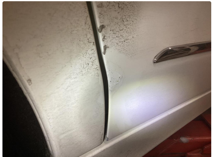
1.2 Flekking av lakk - ufagmessig utført arbeid
