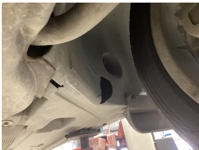
1.7 Plastinnerskjerm mangler en plastbit
