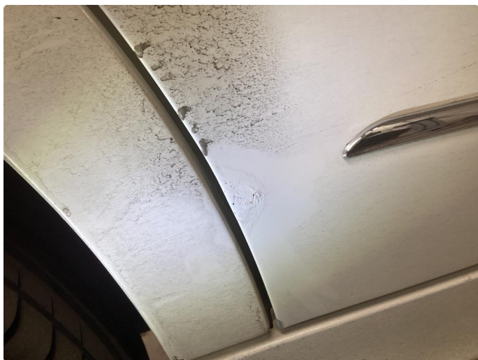
1.4 Flekking av lakk - ufagmessig utført arbeid
