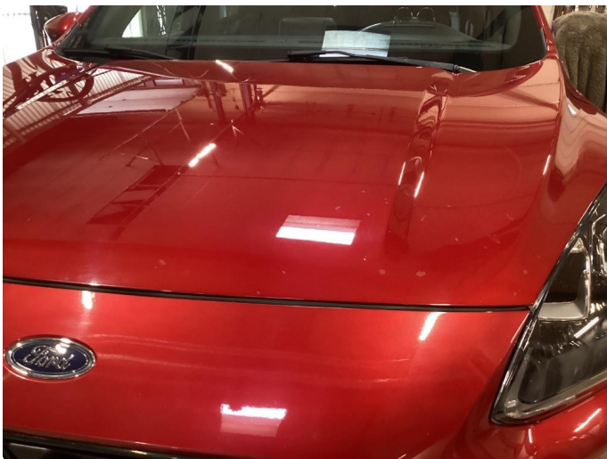
1.1 Steinsprut flekket i med lakk - ufagmessig utført
