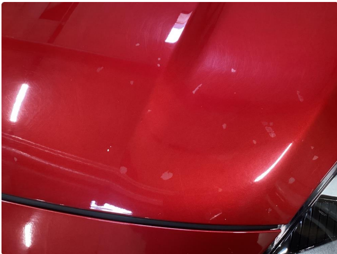
1.1 Steinsprut flekket i med lakk - ufagmessig utført
