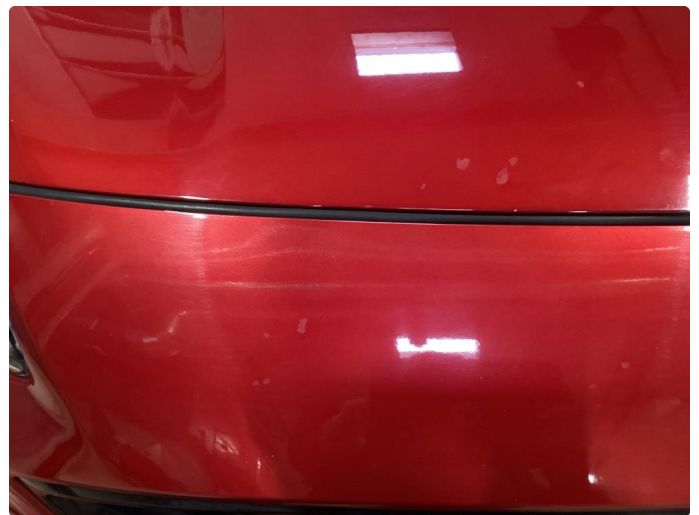
1.1 Steinsprut flekket i med lakk - ufagmessig utført
