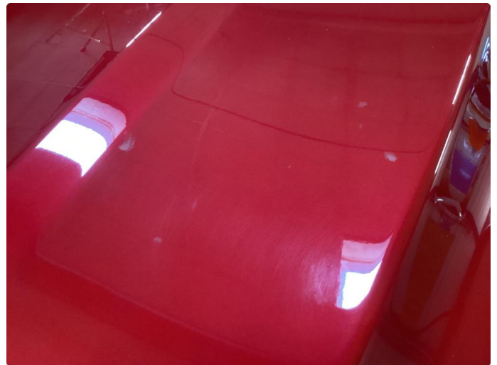
1.1 Steinsprut flekket i med lakk - ufagmessig utført
