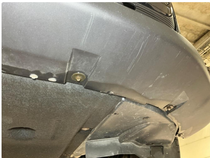
1.3 Foran , skrubbskader underkant
