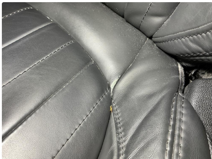
2.1 Noe slitasje førersete
