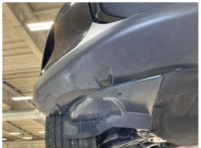
1.3 Foran , skrubbskader underkant
