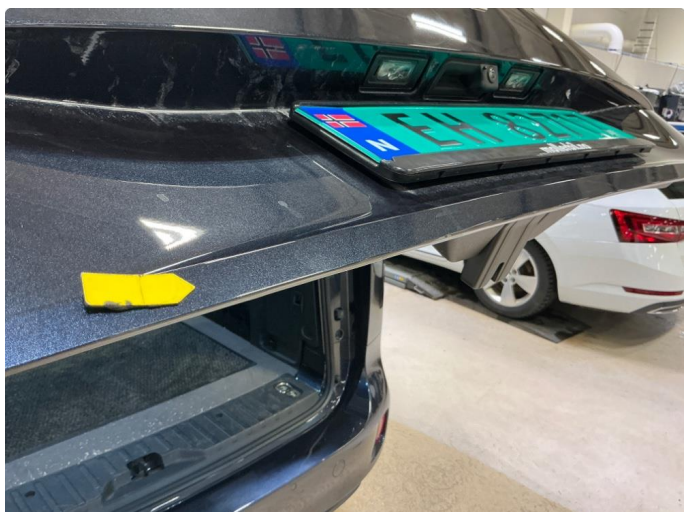
1.1 Skade i plastikk nedre del av bakluke
