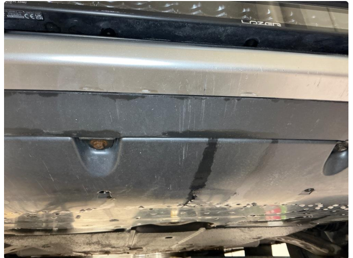
1.2 Støtfanger foran , skrubbskader underkant
