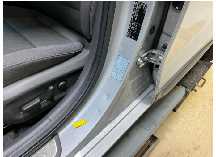
1.2 Flere bulker med lakksår innsteg venstre foran
