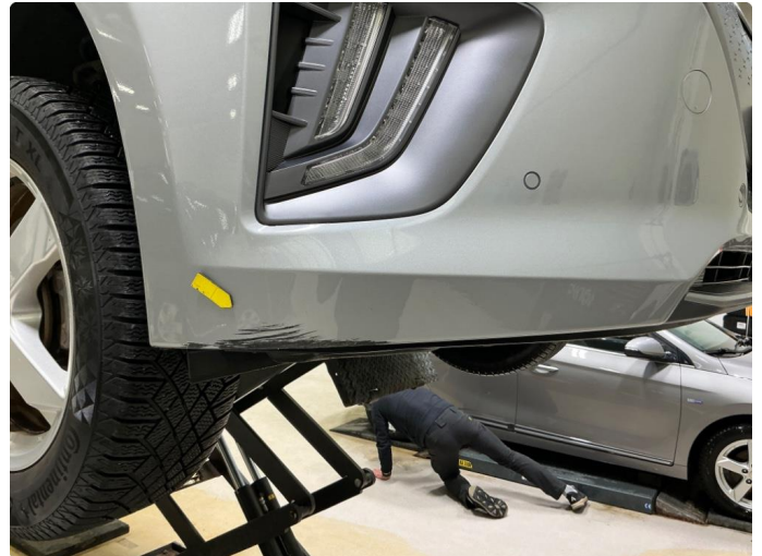
1.4 Riper , støtfangerkappe foran høyre side
