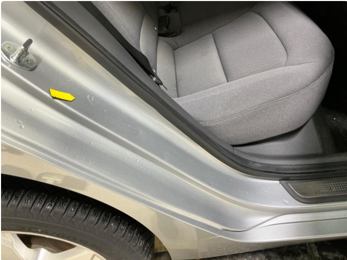
1.3 Flere bulker og lakksår innsteg høyre bak .
