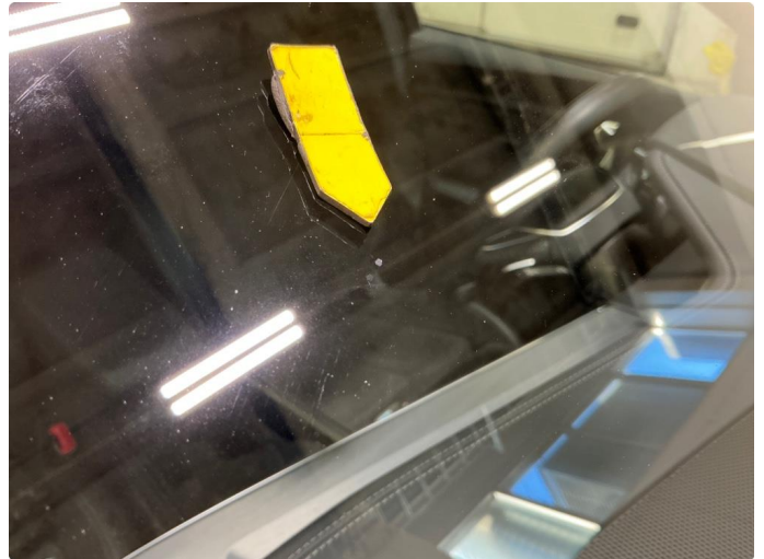
1.1 Tidligere reparert steinsprut - ok
