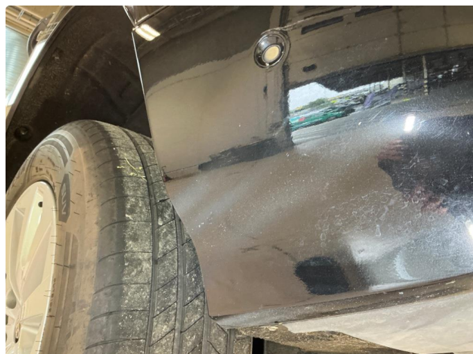
1.2 Støtfanger bak høyre og venstre side - matt lakk fra steinsprut
