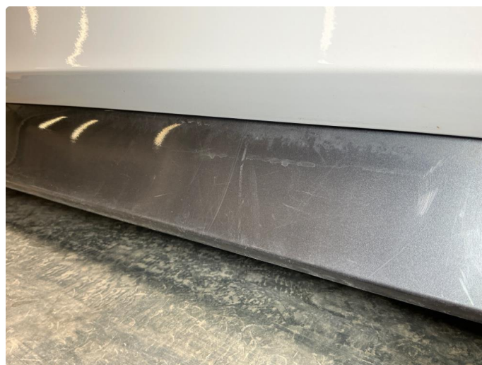
1.5 Kanaldekler begge sider - riper og mekanisk slitasje
