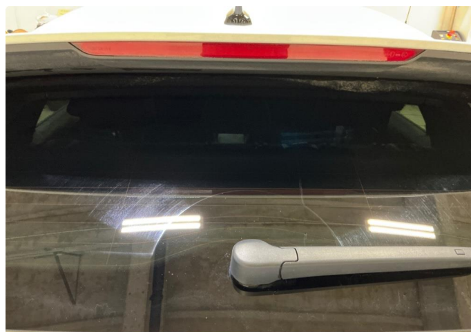
1.4 Mekanisk slitasje bakvindu
