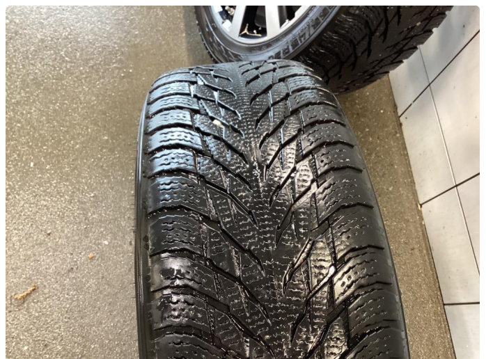
1.3 Skjev slitasje på vinterdekk, alle
