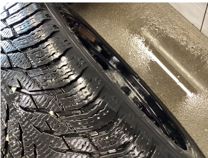
1.3 Skjev slitasje på vinterdekk, alle
