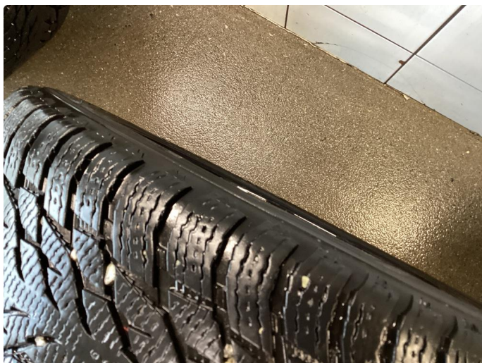
1.3 Skjev slitasje på vinterdekk, alle
