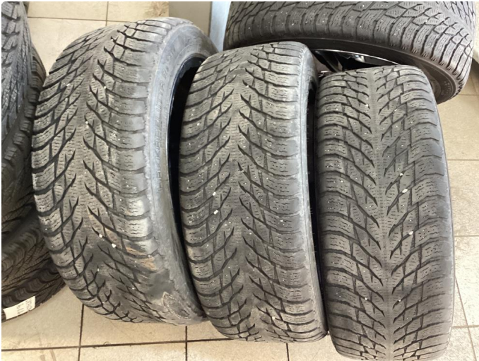
1.1 Skjev slitasje på vinterdekk
